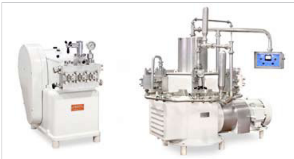
Omogeneizzatore a 3 pistoni, costruito nel 1949 e a 8 pistoni costruito nel 1972
