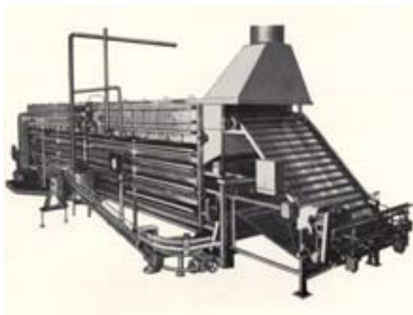
Sterilizzatore raffreddatore-asciugatore continuo a scatola rotante e a pressiozne atmosferica, 1959
