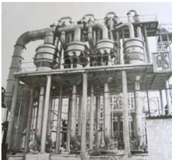
Evaporatore continuo per concentrato di pomodoro, 1975
